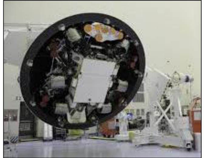
Se encuentra unido a la etapa de descenso un sistema de propulsión que se encarga de situar el rover en la superficie marciana, la etapa de descenso empleaba 8 motores de hidracina denominados MLE (Mars Lander Engines) construidos por Aerojet, por primera vez en una misión planetaria, los MLE tienen empuje regulable, alcanzando un máximo de 3300 N cada uno.
